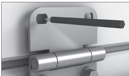
В случае, если в панели не просверлены отверстия верхней части петли, наметьте отверстия для крепления верхних частей внутренних петель и боковых опор.
