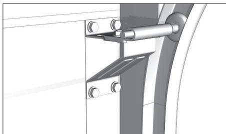
Установите верхнюю панель. Отрегулируйте положение верхнего ролика, обеспечив плотное прилегание панели к проему.
