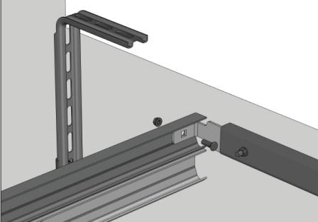
Закрепите С-профиль к концам горизонтальных направляющих с помощью кронштейна и болтов 1/4×3/4 с гайками.
