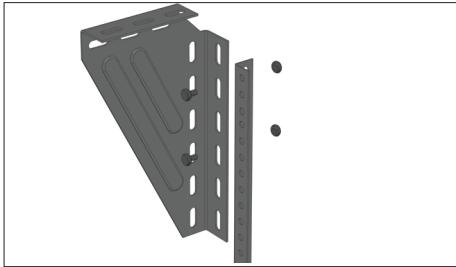
Закрепите перфорированный уголок 32x32 мм при помощи двух болтов на универсальный угловой кронштейн
