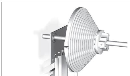
Вставьте вал в сборе с пружиной и барабанами в опорные кронштейны.
