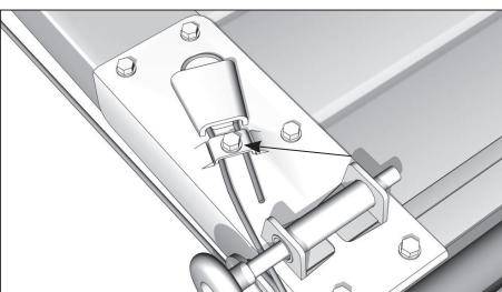
Установите нижние угловые кронштейны на нижнюю панель. Разметьте и просверлите отверстия Ø4,2 мм для его крепления. Закрепите кронштейн 4-я саморезами 6,3×32 мм (как показано на рисунке).
