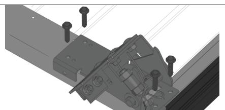
Установите устройство защиты от обрыва троса на нижнюю панель. Разметьте и просверлите отверстия Ø4,2 мм для его крепления. Закрепите кронштейн 4-я саморезами 6,3×32 мм (как показано на рисунке).
