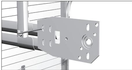
Приставьте концевой опорный кронштейн к горизонтальным направляющим с наружной стороны. По перфорации в кронштейне разметьте отверстия в направляющих для его крепления.
