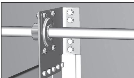
Закрепите концевой опорный кронштейн к стене проема при помощи четырех саморезов с шайбами и дюбеляй. В зависимости от типа барабана расположите и закрепите регулируемый подшипник по отверстиям в кронштейне. Аналогично закрепите второй опорный кронштейн.
