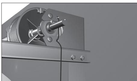
Второй конец фала закрепите в любом свободном отверстии угловой стойки или концевом опорном кронштейне.
