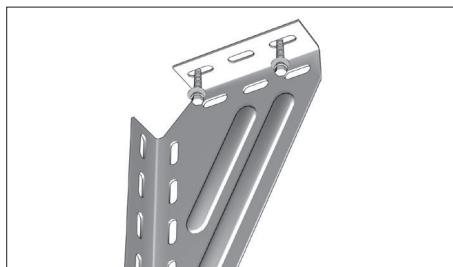
Просверлите отверстия сверлом Ø12 мм и вставьте дюбели. Закрепите кронштейн при помощи саморезов с шайбами.
