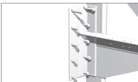
Закрепите кронштейн к стене при помощи дюбелей с саморезами и к угловой стойке при помощи болтовых соединений. Аналогично установите второй кронштейн с другой стороны проема.
