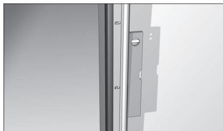
Закрепите угловые стойки к стене проема 2-я саморезами с шайбами, но не затягивайте их. Выставьте вертикальные направляющие по уровню и только после этого затяните саморезы.
