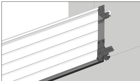
Перед установкой направляющих необходимо установить в проем нижнюю панель таким образом, чтобы ее края заходили за проем равномерно с двух сторон.
