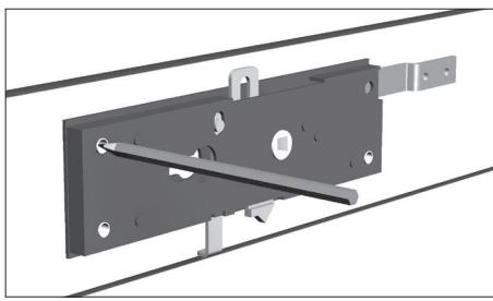
Приложите корпус замка к панели с учетом длины тяги, соединяющей его с защелкой замка, и разметьте отверстия для крепления замка под ручку замка и его цилиндр.
