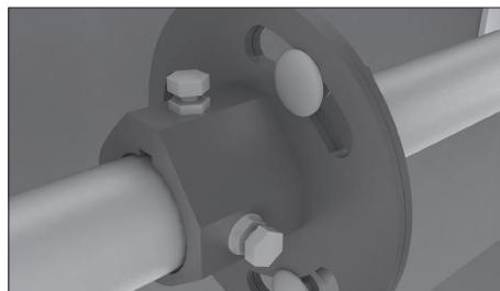
Ослабьте болты соединяющие две части муфты. Отрегулируйте натяжение тросов путем вращения двух частей вала. Зафиксируйте новое положение муфты при помощи болтов с гайками.
