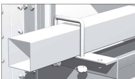
Закрепите трубу к кронштейнам с помощью скоб и гаек согласно монтажной карте.
