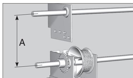
Установите второй вал с пружиной в подшипники верхних опорных кронштейнов.
