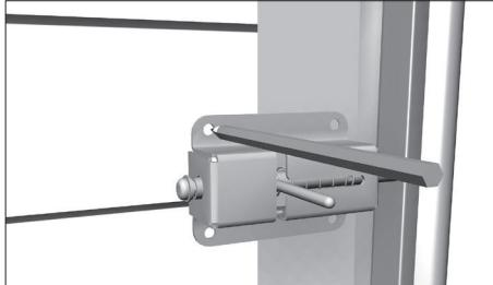
Разметьте и просверлите 4 отверстия сверлом  $\varnothing 4$  мм на глубину 15–20 мм с внутренней стороны ворот для крепления корпуса защелки.
