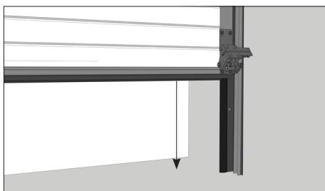
Вставьте ролики в роликодержатели нижних угловых кронштейнов и установите нижнюю панель. Установите ролики с роликодержателями на боковые опоры.
