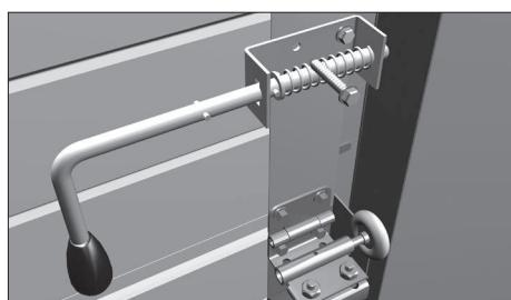
Закрепите задвижку к панели при помощи четырех саморезов. Проверьте работу задвижки.
