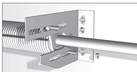
Просверлите намеченные отверстия 12 мм и закрепите промежуточный кронштейн при помощи саморезов с шайбами и дюбелей.
