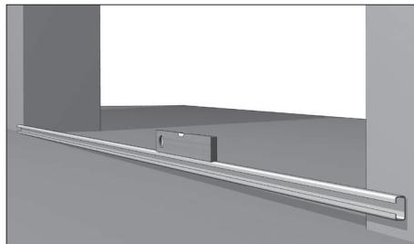
Перед установкой вертикальных направляющих необходимо проверить горизонтальность пола. Для чего положите С-профиль на пол и проверьте его горизонтальность с помощью строительного уровня.
