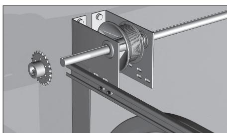
Установите на вал звездочку, предварительно вставив шпонку в шпоночный паз. Зафиксируйте звездочку на валу крепежными болтами M8x25 мм. Аналогично закрепите звездочку на валу с другой стороны проема.
