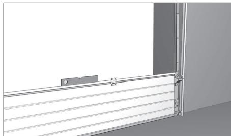
Затем по панели установите вертикальные направляющие. Расстояние от торцевой поверхности панели до кромок направляющих должно составлять около 25–30 мм.
