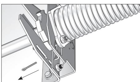
Закрепите фланец пружины к рычагу защелки двумя болтами с гайками.
