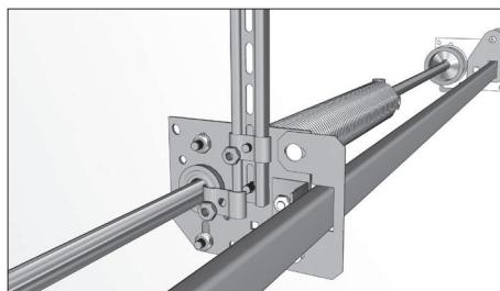
Закрепите сборку к потолку с помощью кронштейнов (тип кронштейна зависит от высоты притолоки).
