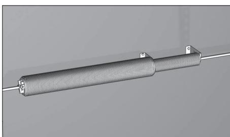
Закрепите торсионный механизм на валу прижимными винтами. Установите универсальный внутренний кронштейн для крепления окончания пружины 95 мм и разметьте места для его крепления.
