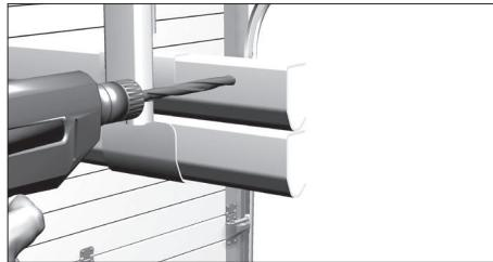
Просверлите намеченные отверстия сверлом 8,5 мм.
