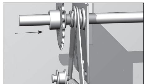
Установите звездочку вместе с цепью вплотную к устройству натяжения цепи.
