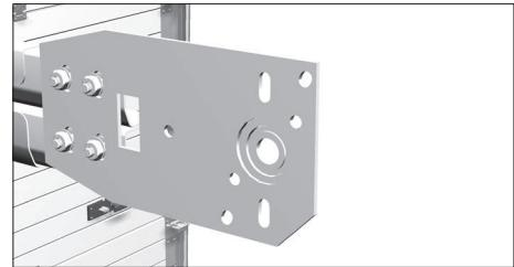
Закрепите концевой опорный кронштейн к двойным горизонтальным направляющим при помощи болтов с гайками.
