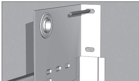
Установите опорный кронштейн вплотную к стене и угловой стойке, совместив при этом отверстия в кронштейне и стойке. Разметьте отверстия для крепления к С-профилю и стене проема по перфорации в опорном кронштейне.
