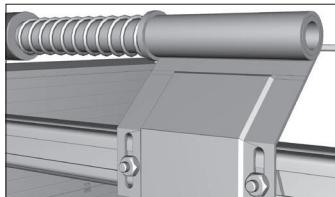
Закрепите амортизатор к С-профилю на обоих концах направляющих при помощи закладных пластин и болтов с гайками. Установите амортизатор таким образом, чтобы при открытых воротах он находился в сжатом состоянии не менее 50% от длины его хода.
