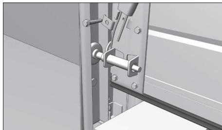
Выверните саморез, крепящий свободный конец троса, с помощью скобы крепления троса к основанию кронштейна, расположенного на приподнятом углу полотна ворот. Снимите скобу.
