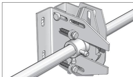
Данный механизм служит для защиты от падения щита при обрыве пружины. Приставьте кронштейн к стене проема и наметьте места его крепления к стене.
