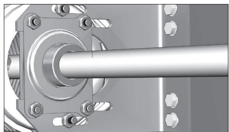
Установите универсальный внутренний кронштейн к стене проема, разметьте и просверлите отверстия сверлом 12 мм в стене проема. Вставьте дюбели и закрепите кронштейн 4-мя саморезами с шайбами. Зафиксируйте регулируемый подшипник на внутреннем кронштейне при помощи болтовых соединений M10x45 мм. Закрепите фланец пружины к внутреннему кронштейну.
