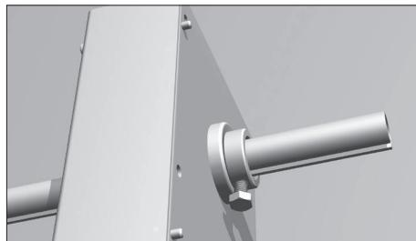
Закрепите стопорные кольца на валу болтами M8×25 мм (болты должны упираться в шпоночный паз).
