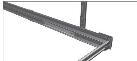
Разметьте и просверлите по два отверстия 8 мм в нижних горизонтальных направляющих.
