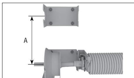
Установите на верхний и нижний валы звездочки таким образом, чтобы они располагались на одной линии. Предварительно наденьте на них цепь. Если межцентровое расстояние между валами (A) меньше 393 мм, то согласно таблице 1 укоротите цепь. Аналогично установите звездочки с другой стороны проема.
