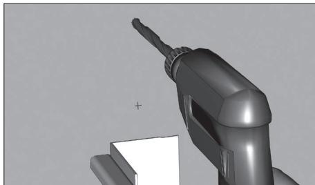
Просверлите намеченные отверстия (в стене сверлом 12 мм и в С-профиле 8,5 мм).
