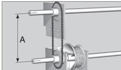
Установите на второй вал звездочку таким образом, чтобы она располагалась на одной линии с нижней звездочкой. Предварительно наденьте на них цепь. Если межцентровое расстояние между валами (A) меньше 393 мм, то согласно таблице 1 укоротите цепь.
