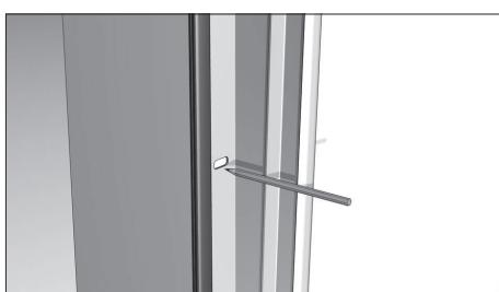
Разметьте отверстия в стене проема, используя перфорацию в угловой стойке в качестве шаблона.
