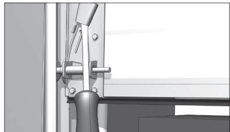
С помощью отвертки слегка поднимите узкий конец клина. При этом ослабнет затяжка троса, и он начнет проскальзывать, а приподнятый угол полотна опускаться. Как только полотно будет одинаково соприкасаться с одной стороны с полом, а с другой с подкладкой, осадите молотком клин и зафиксируйте свободный конец троса при помощи скобы и самореза. Еще раз проверьте натяжение тросов(они должны быть равномерно натянуты и не должны цеплять за конструкцию ворот).
