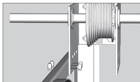
Вставьте вал с пружиной в подшипники кронштейнов и установите барабаны. Закрепите правый и левый опорные кронштейны к стене с помощью саморезов с шайбами и к угловым стойкам с С-профилями при помощи болтов с гайками.
