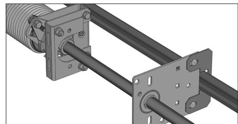
Прикрепите кронштейн крепления для барабана сзади к С-профилю при помощи кронштейна крепления С-профиля, монтажного угольника для установки горизонтальной планки, закладной пластины и болта с гайкой.
