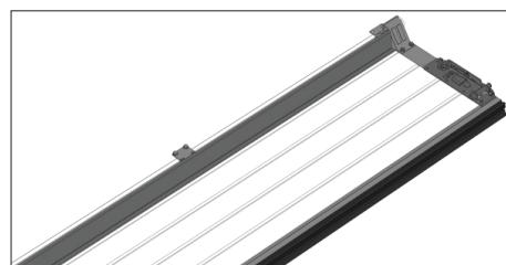
Омега-профиль устанавливается на проемах с шириной щита > 4700 мм и в случаях повышенной ветровой нагрузки. Профиль служит для усиления жесткости щита, как в вертикальном, так и в горизонтальном положении.
