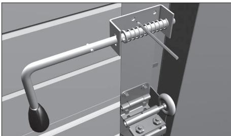
Установите задвижку на высоте, удобной для открывания. Разметьте отверстия для крепления.
