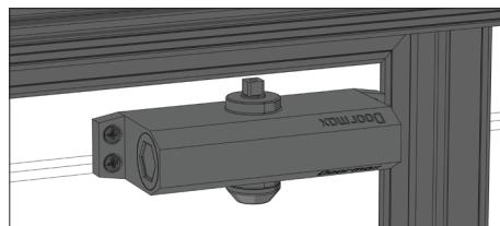
Установите корпус доводчика по 4-м отверстиям, просверленным на производстве в полотне калитки.
