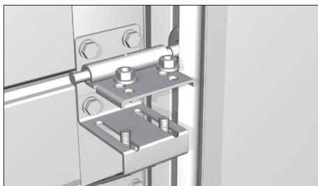
На боковые опоры установите роликодержатели с роликами.
