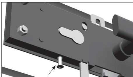
Установите цилиндр и закрепите его к корпусу замка с помощью винта.
