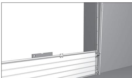
Выровняйте нижнюю панель по строительному уровню. При необходимости используйте подкладки соответствующей толщины.
