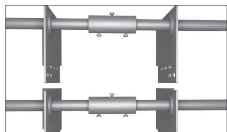
При использовании соединительных муфт опорные кронштейны устанавливаются с обеих сторон от муфт.
