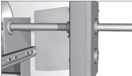
Установите на вал ручной цепной привод, предварительно вставив шпонку в шпоночный паз.
