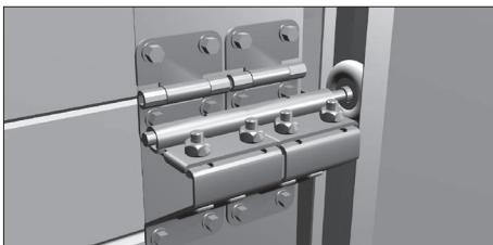
Двойные (усиленные) боковые опоры роликов используются в случае больших габаритов полотна ворот, когда нагрузка на один ролик превышает 35 кг.
