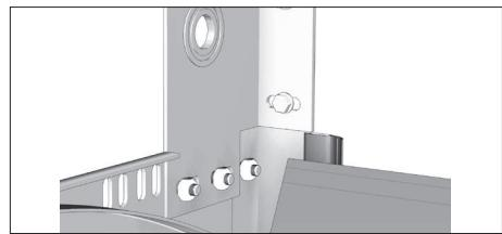
Закрепите кронштейн к стене при помощи дюбелей и саморезов с шайбами и при помощи болтов с гайками к кронштейну крепления шкива и угловой стойке.
