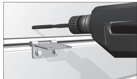
Просверлите намеченные отверстия  $\varnothing 4$  мм на глубину 25–30 мм.
