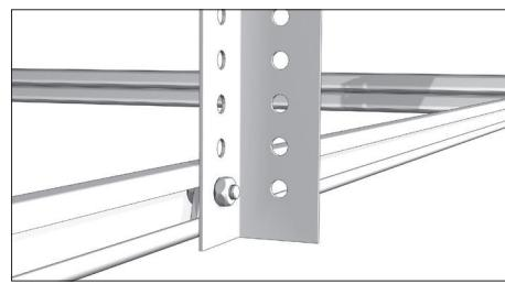
При высоте притолоки от 1500 мм направляющие крепятся при помощи перфорированного уголка 32×32 мм.
