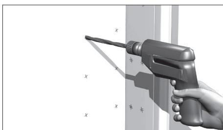
Просверлите по разметке в стене проема десять отверстий сверлом 12 мм и восемь отверстий в угловой стойке сверлом 7 мм.
