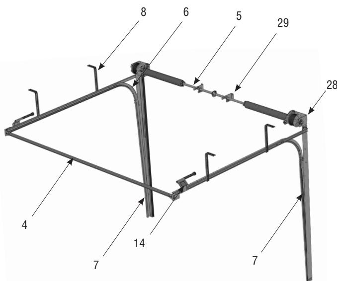
Система направляющих и тормозных механизмов
