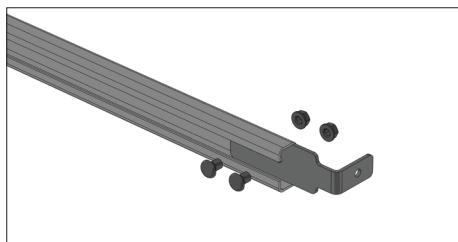
Закрепите соединитель на «с» профиль с помощью болтов  $1/4 \times 3/4$  с гайками..
