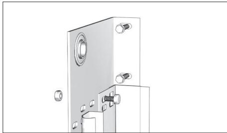
Просверлите намеченные отверстия в стене сверлом Ø12 мм. Забейте в стену дюбели. Скрепите концевой опорный кронштейн и угловую стойку между собой при помощи болтов M8×25 с гайками.
