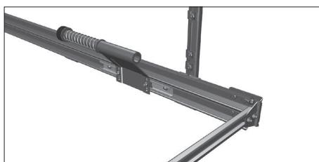
Закрепите С-профиль с помощью болтов с полукруглой шляпкой M8×25 и гаек с фланцем. Закрепите пружинный амортизатор с помощью закладных пластин и болтов с гайками. Отрегулируйте положение амортизатора и затяните гайки.
