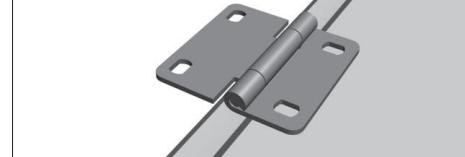
Установите внутренние петли по отверстиям в панели, ранее сделанным на производстве. Отверстия в нижней части петли должны совпадать с отверстиями в панели, сделанными на производстве.
