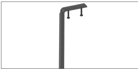
Просверлите отверстия сверлом Ø10 мм и вставьте дюбели. Закрепите кронштейн при помощи саморезов с шайбами.
