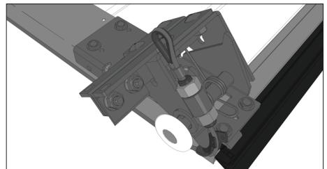
Закрепите устройство от обрыва пружины к концевому опорному П-образному кронштейну при помощи двух комплектов крепежных элементов (болт 10×25, гайка M10, шайба 10 гроверная).
