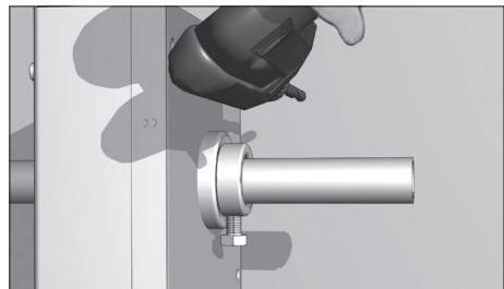
Просверлите размеченные отверстия сверлом Ø12 мм.
