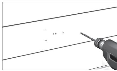
Просверлите намеченные отверстия: 3 отв.  $\varnothing 5,5$  мм для крепления замка, под ручку замка и цилиндр — сверлом  $\varnothing 19$  мм.
