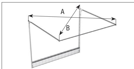
Проверьте горизонтальность направляющих с помощью строительного уровня (при необходимости отрегулируйте). Перед окончательным креплением направляющих к потолку необходимо проверить расстояние между противоположными углами (диагонали А и В должны быть одинаковы).
