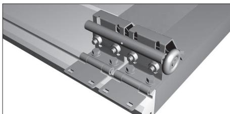
Разберите боковые опоры с держателями роликов. Установите опоры по просверленным отверстиям и закрепите при помощи саморезов для панелей.
