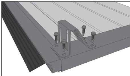
Установите верхние опоры ролика и закрепите при помощи саморезов для панелей.
