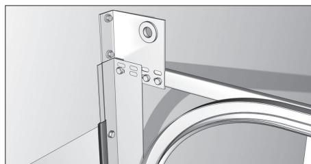
Установите концевой опорный кронштейн по отверстиям на угловой стойке. По перфорации в кронштейне разметьте отверстия для крепления в стене проема. Просверлите намеченные отверстия в С-профиле сверлом Ø8,5 мм и в стене сверлом Ø12 мм. Забейте в стену дюбели. К стене закрепите концевой опорный кронштейн при помощи саморезов. Скрепите концевой опорный кронштейн, С-профиль и угловую стойку между собой при помощи болтов M8×25 с гайками.
