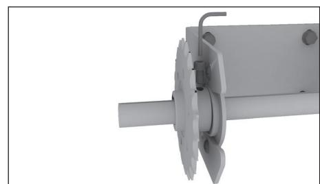
Зафиксируйте звездочки крепежными болтами.
