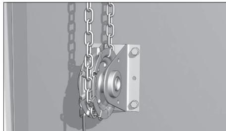
Проденьте цепь через привод и натяжной ролик.
