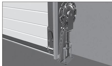
Установите натяжной ролик на полу, на одной оси с приводом. Разметьте и просверлите отверстия в полу для крепления натяжного ролика.
