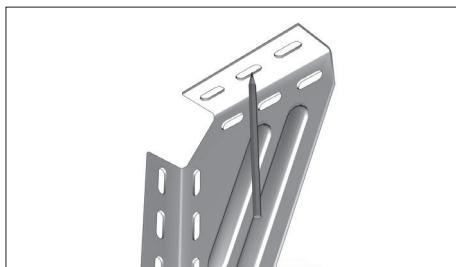
Разметьте отверстия для крепления кронштейна к потолку.
