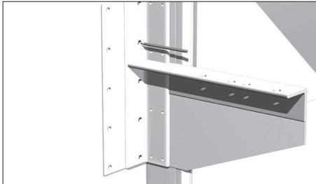
Прислоните выносной кронштейн для низкого вала к стене проема вплотную к угловой стойке (с внешней стороны) согласно монтажной карте. По перфорации в кронштейне сделайте разметку для его крепления к стене и угловой стойке.
