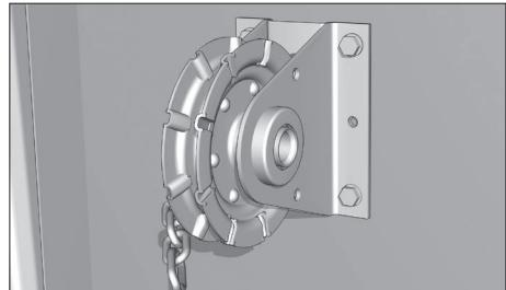
Вставьте дюбели в просверленные отверстия и закрепите натяжной ролик при помощи саморезов.
