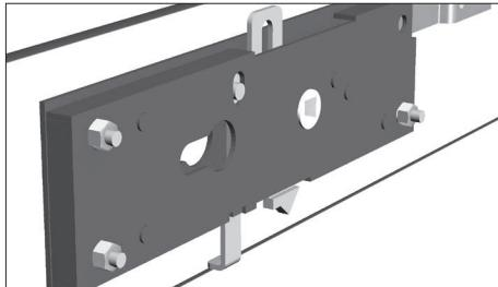
Установите наружную накладку и скрепите ее с корпусом замка при помощи трех винтов с гайками, входящих в комплект замка.
