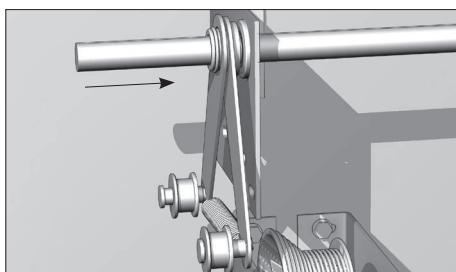
Установите устройство натяжения на верхний вал вплотную к концевому опорному кронштейну перед установкой звездочки и цепи.
