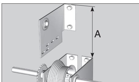
Приставьте опорный кронштейн для второго вала вплотную к стене таким образом, чтобы по вертикали он находился на одной линии с нижним кронштейном, закрепленным к угловой стойке и стене. В зависимости от высоты притолоки межцентровое расстояние между валами (A) может изменяться от 240 до 393 мм. Исходя из этих размеров устанавливается верхний опорный кронштейн. Размер указан в карте монтажника. Аналогично закрепите опорный кронштейн для второго вала с другой стороны проема.
