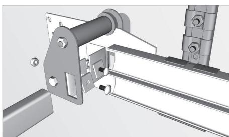
Установите и закрепите ролик, направляющий трос, для барабана сзади совместно с монтажным угольником для установки горизонтальной планки на концевом опорном кронштейне при помощи болта с гайкой. Установите и закрепите С-профиль с помощью монтажных угольников, закладных пластин болтами с полукруглой головкой M8×25 соответствующими гайками.
