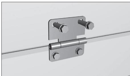
Закрепите верхние части петель с помощью саморезов для панелей.
