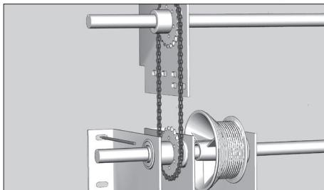
Установите дополнительный опорный кронштейн на нижний вал, для чего приставьте его к стене проема, наметьте и просверлите отверстия для крепления.
