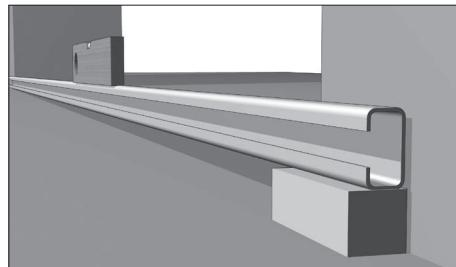
Если для выравнивания С-профиля необходимы подкладки, то эти подкладки нужно использовать при установке вертикальных направляющих.
