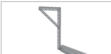
Приложите монтажный уголник к направляющим в месте крепления. Отметьте и просверлите отверстия в потолке. Закрепите монтажный уголок с помощью саморезов с шайбами и дюбелей.
