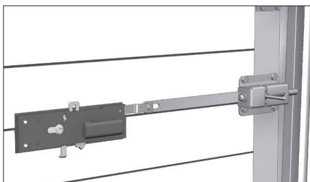
Установите тягу, соединяющую уголок защелки и язык замка.
