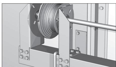
Вставьте вал с пружиной в подшипники кронштейнов и установите барабаны.
