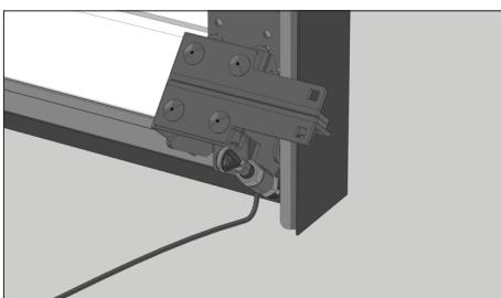
Один конец капронового фала закрепите к втулке ролика на нижнем угловом кронштейне.
