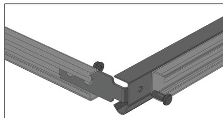
Закрепите С-профиль к концам горизонтальных направляющих с помощью болтов  $1/4 \times 3/4$  с гайками.
