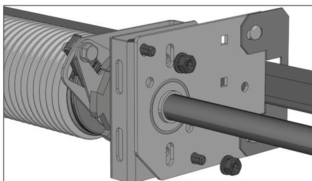
Закрепите пружину к кронштейну крепления для барабана сзади двумя болтами с гайками.
