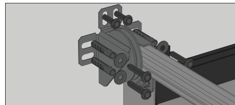
По отверстиям в угловой стойке установите шкив и зафиксируйте при помощи 4 болтов с полу- круглой головкой M8×16. Разметьте и просверлите отверстия Ø8 мм в стене притолоки.
