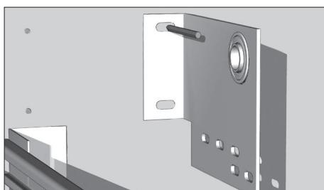
Симметрично с внутренней стороны установите второй опорный кронштейн, для чего приставьте его к стене проема и наметьте места его крепления к стене. Расстояние между кронштейнами должно быть таким, чтобы можно было разместить барабан.
