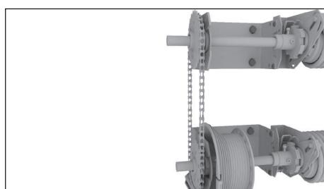
Установите на звездочки соединительную цепь. В зависимости от межцентрового расстояния расположения валов, укоротите цепь, согласно таблице указанной в монтажной карте.
