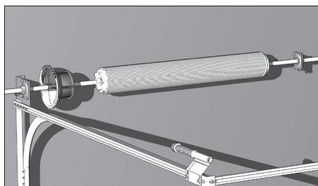
Установите на вал барабаны, пружину и подшипник универсального опорного кронштейна. Вставьте вал в подшипники опорных кронштейнов.
