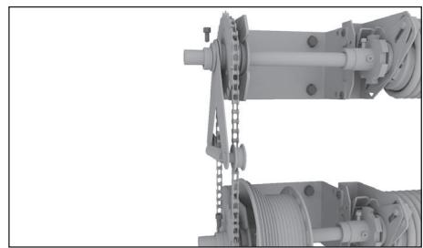
На верхний вал установите натяжитель цепи. Зафиксируйте положение натяжителя цепи стопорным кольцом.
