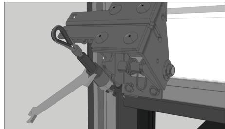
Отрегулируйте трос посредством кручения ключом гаек, расположенных на металлической втулке, через которую проходит трос. При откручивании верхней гайки натяжение троса ослабевает, при закручивании наоборот усиливается. Как только полотно будет одинаково соприкасаться с одной стороны с полом, а с другой с подкладкой зафиксируйте металлическую втулку путем закручивания нижней гайки.
