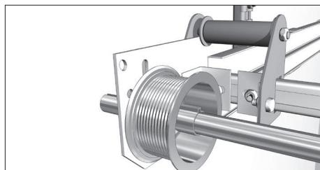
Установите вал в подшипники концевых опорных кронштейнов, предварительно установив на него барабаны, пружину и кронштейн крепления для барабана сзади.
