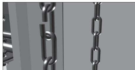
Проденьте цепь через привод и натяжной ролик.
