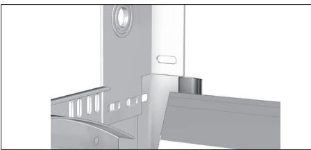
Установите опорный кронштейн вплотную к стене и угловой стойке, совместив при этом отверстия в опорном кронштейне, угловой стойке и кронштейне для крепления шкива.
