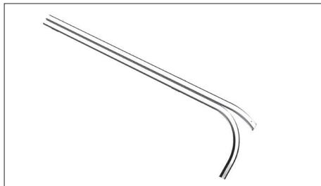
Горизонтальные направляющие поставляются в сборе. В них перфорированы отверстия для крепления с вертикальными направляющими.
