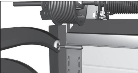
При сборке верхней панели установите верхние опоры ролика. Выровняйте края углового кронштейна по панели, просверлите 4 отверстия 4,2 мм и закрепите его при помощи саморезов для панелей ворот.
