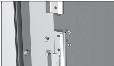
Скрепите горизонтальные и вертикальные направляющие между собой при помощи двух болтов для сборки направляющих с гайками и соединительной пластины, располагающейся в месте стыка направляющих.
