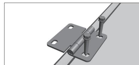
Закрепите петли при помощи 2-х саморезов.
