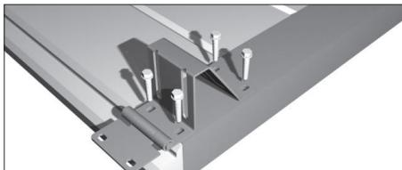
Установите боковые опоры по просверленным отверстиям, используя 4 самореза 6,3×32 мм.
