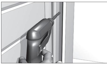
Откройте ворота и просверлите отверстие  $\varnothing 15$  мм в угловой стойке для вхождения ригеля замка.
