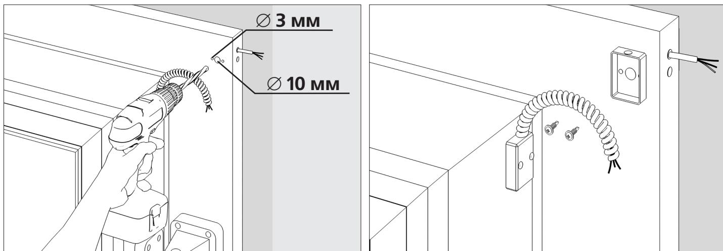
Просверлите отверстие в раме  $\varnothing 10$  мм для вывода обогревающего кабеля. Просверлите два отверстия  $\varnothing 3$  мм для  $\varnothing 3,5$  мм.
