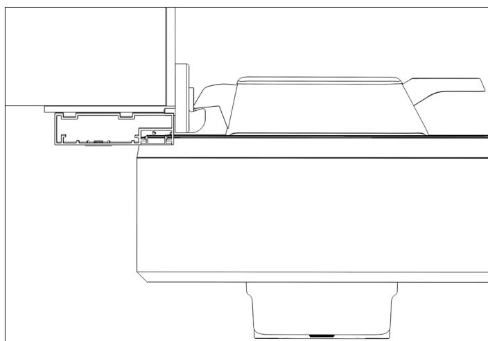
С помощью ответной части замка обеспечьте прилегание уплотнителя полотна двери к раме.
