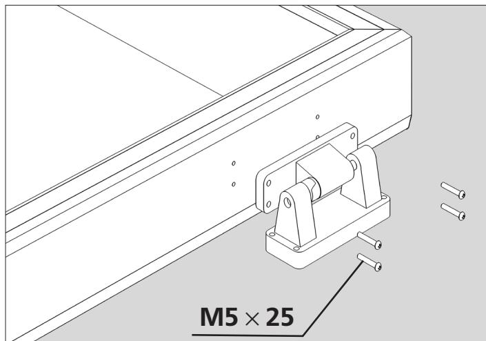
Через отверстия на полотне двери установите петли с помощью винтов M5 × 25. Эксцентриковая часть петли должна находиться снизу.
