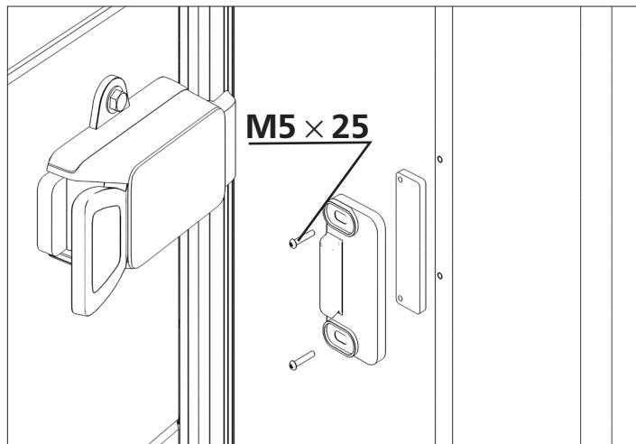
В заранее подготовленные отверстия на полотне двери установите ручку с замком, втулки, шток замка.
