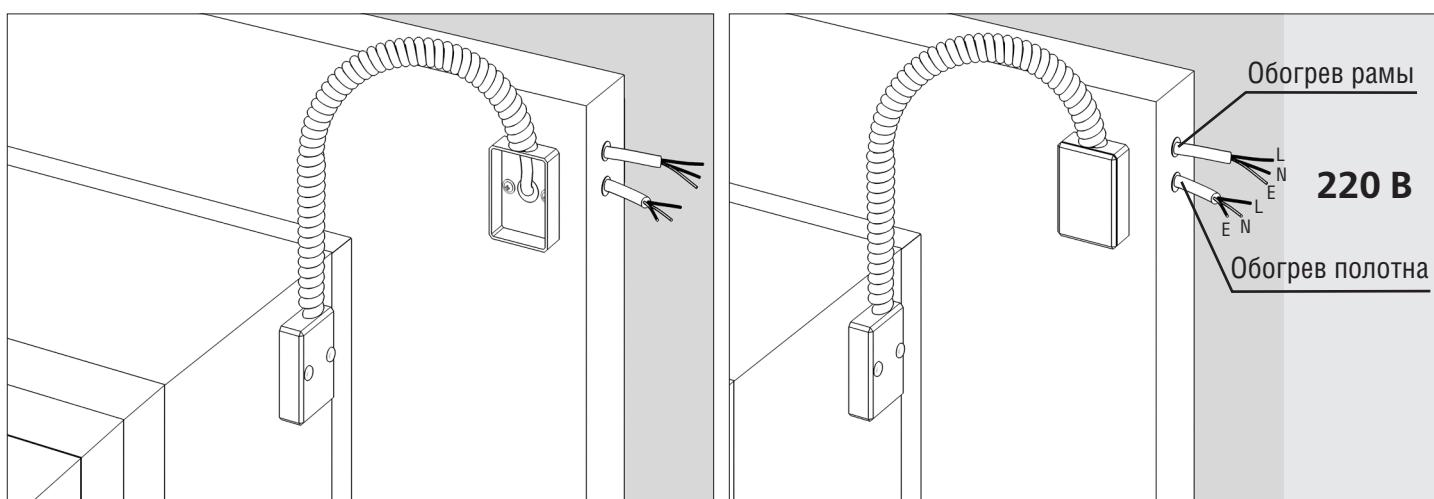
Выполните соединение обогревающего кабеля через монтажную коробку. Закройте монтажную коробку декоративной крышкой.
