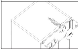
3. Установка на металлические конструкции
