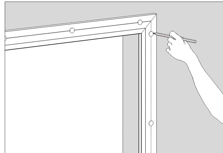
Зафиксируйте раму к проему. Проверьте вертикальность и горизонтальность установки рамы с помощью уровня; разность диагоналей должна составлять не более 3 мм.
