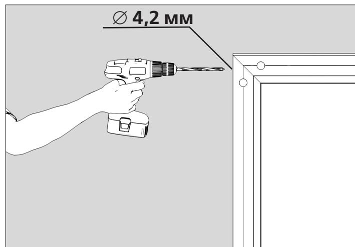
Через отверстия в рамках рассверлите сверлом  $\varnothing 4,2$  мм отверстия в алюминиевых сухарях ( $50 \times 50$ ).
