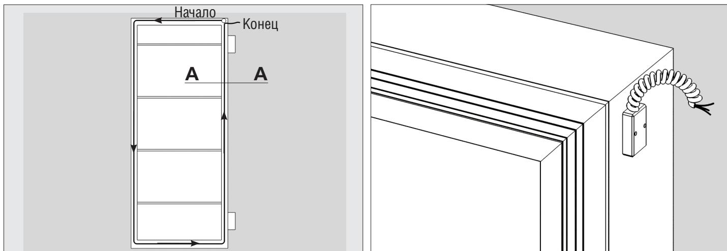
Схема установки обогрева на полотне двери.
