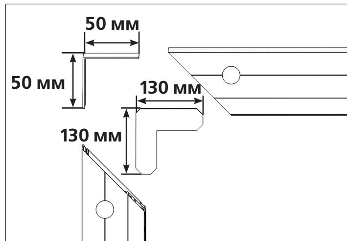
Разложите на ровной, чистой поверхности вертикальные и горизонтальную стойки рамы. Установите алюминиевые сухари ( $50 \times 50$ ) и стальные позиционные уголки ( $130 \times 130$ ) в стойки и соедините все элементы между собой.
