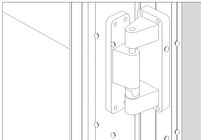
Через отверстия на алюминиевой раме установите петли с помощью винтов M5 × 25. Навесьте полотно двери на раму.
