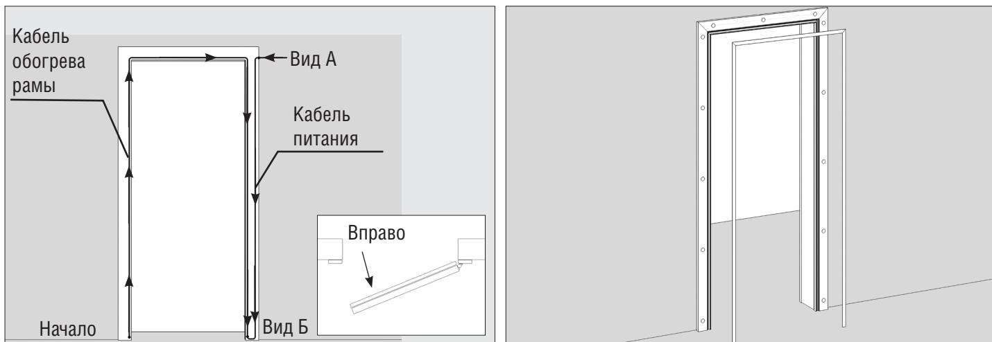
Схема установки обогревающего кабеля на раме распашной двери. Снимите декоративные крышки.
