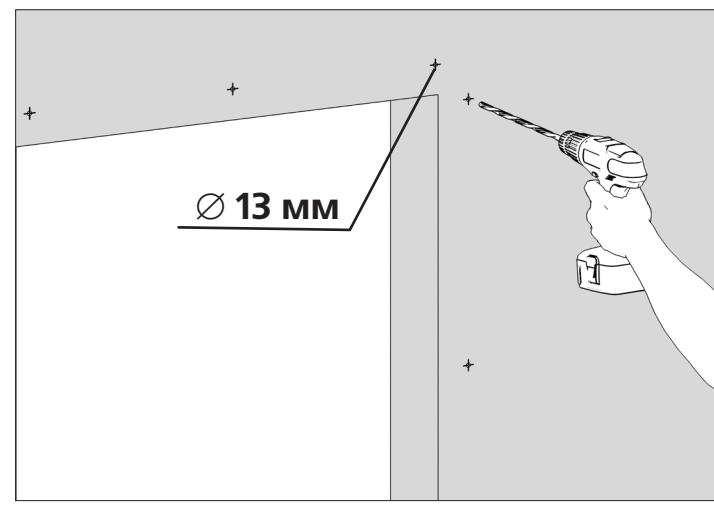
В случае установки двери на сэндвич-панель просверлите сквозные отверстия Ø 13 мм.
