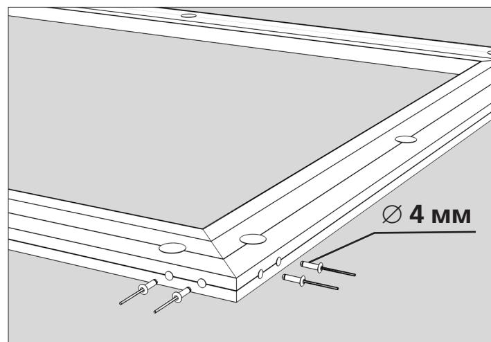
Заклепками  $\varnothing 4,0$  мм скрепите вертикальные стойки рамы с горизонтальной поперечиной. Обеспечьте наиболее плотное прилегание профилей друг к другу.
